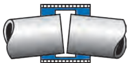
Winkelabweichung bis max. 4° pro Muffe
