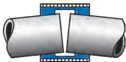
Winkelabweichung bis max. 4° pro Muffe
