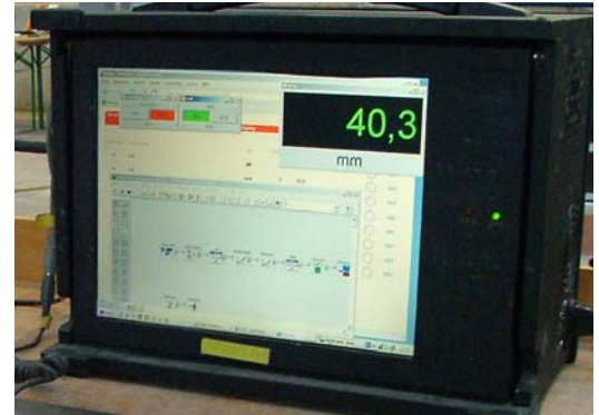
Bild 18: Kontrolle der Verschiebung am Rohrende
