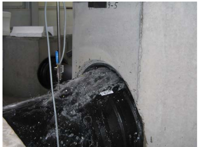
Bild 8: Schachtanschluss H1699-5: Abwinklung von 96 mm/m bzw. 5,5° (155 mm am Rohrende), Versagen der PE-Verbindung, starker Wasseraustritt
