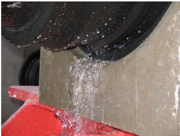
Bild 8: Schachtanschluss H1699-5: Abwinklung von 96 mm/m bzw. 5,5° (155 mm am Rohrende), Versagen der PE-Verbindung, starker Wasseraustritt
