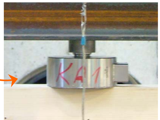
Bild 20: Kraftmessdose am Rohrende
