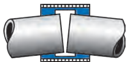
Winkelabweichung bis max. 4° pro Muffe
