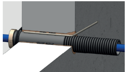
Abb. 4 Montage der Mauerdurchführung
