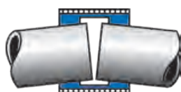
Winkelabweichung bis max. 4° pro Muffe
