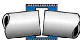
Winkelabweichung bis max. 4° pro Muffe
