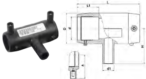
Abbildung und technische Zeichnung für die Dimensionen 20 mm bis 75 mm
