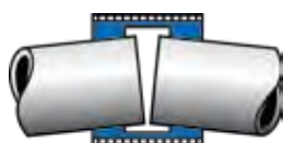
Winkelabweichung bis max. 4° pro Muffe
