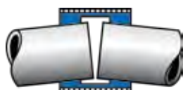
Winkelabweichung bis max. 4° pro Muffe
