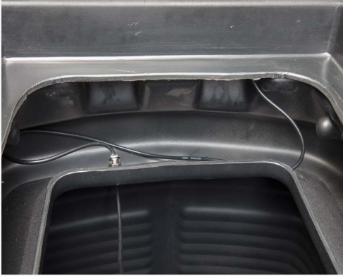
Abb.: 2 Konstruktion des Antennenkabels im oberen Schachtrand
