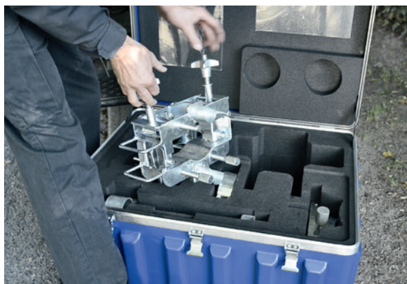
PLASSON ArmEx Armaturenwechsler – Armaturenwechsel in nur 2 Sekunden.
